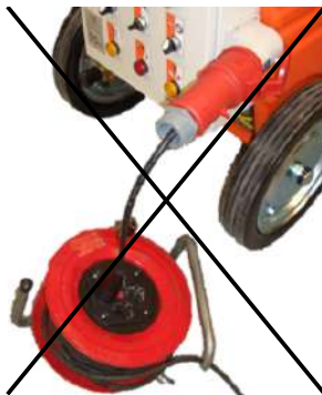
Abb. 34: Beispielbild für unzulässige Anschlussvariante
