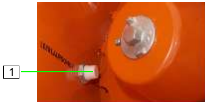
Abb. 27: Füllstandsonde im Materialbehälter
